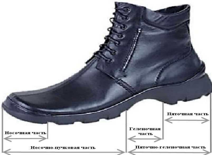
Рисунок Б.1 – Основные структурные части стопы, учитываемые при проектировании обуви
