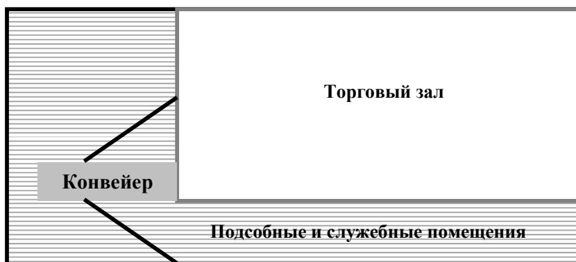
Рис. 7. Расположение подсобных и служебных помещений в подвале или на первом этаже здания
