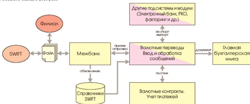
Рис. 8. Схема основных информационных потоков модуля Валютные переводы
