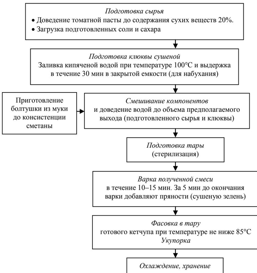
Рисунок 2 – Технологическая схема производства кетчупов
