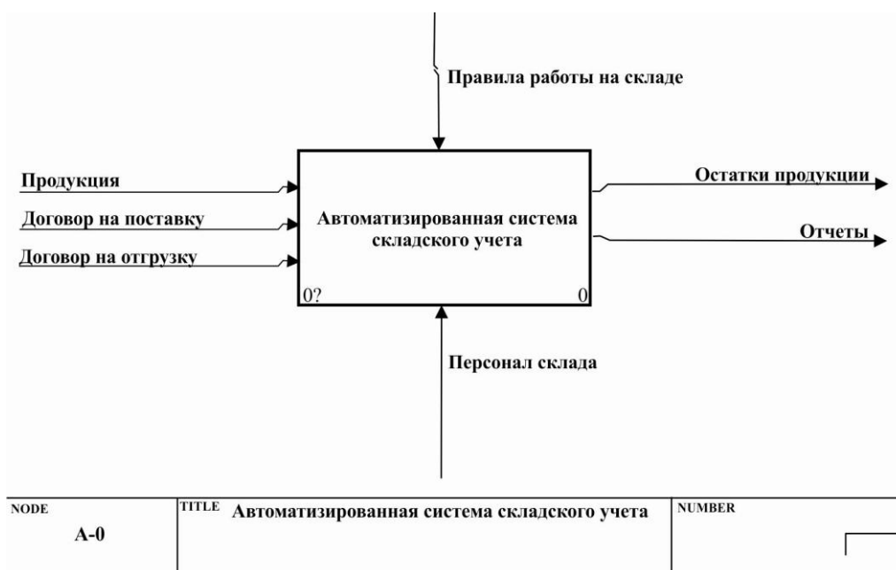
Рисунок 2 – Схема автоматизированной системы складского учета
