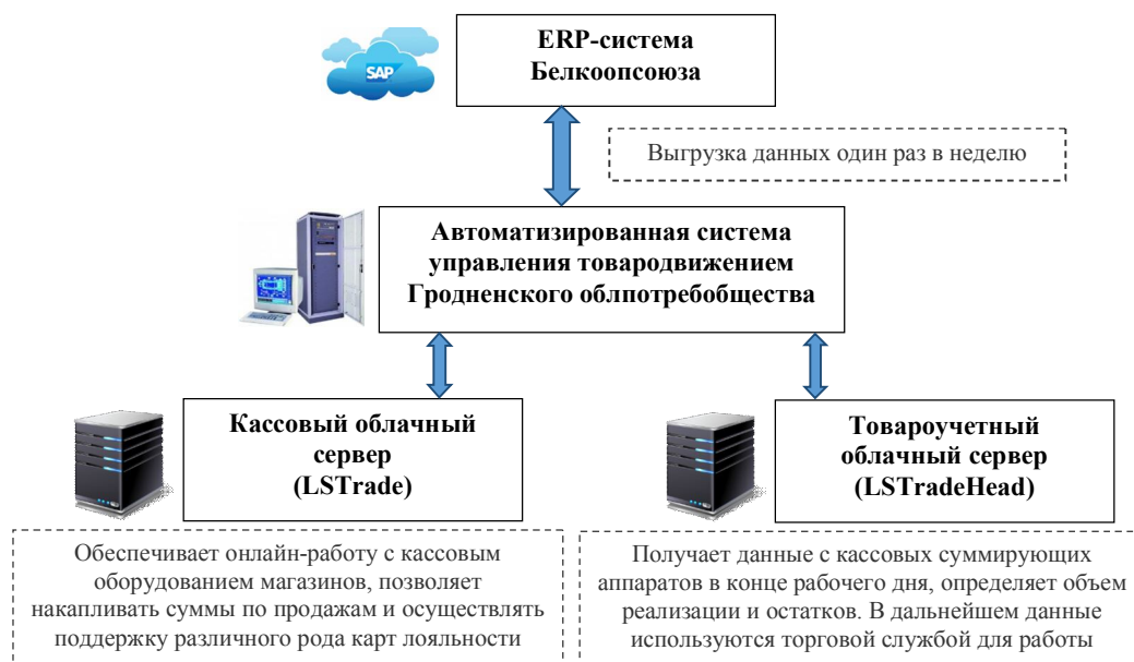
Рисунок 2 – Принципиальная схема автоматизации расчетно-кассовых операций и управления товародвижением на примере филиала Гродненского облпотребщества
