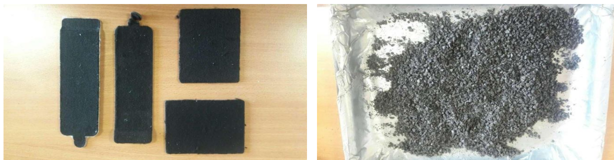
Отходы листового полипропилена: исходные (слева) и после отделения полиэфирной ткани и измельчения (справа)
