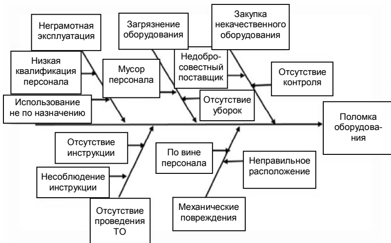
Рисунок 26 – Образец построения диаграммы рыбьего скелета (Fish Bone) К. Исикавы поломки оборудования
