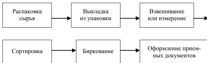
Рис. 2. Схема технологического процесса приемки кожевенного сырья на складе коопзаготпрома
