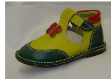
Рисунок 1.4 – Крепление подошвы прошивным методом
